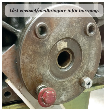
Uppfräsning av centrumhålet i "back plate".
