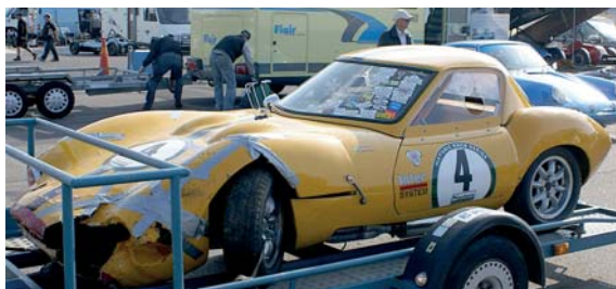
Ginetta efter styrsstagsbrott och närkontakt med räcke på Falkenberg.
