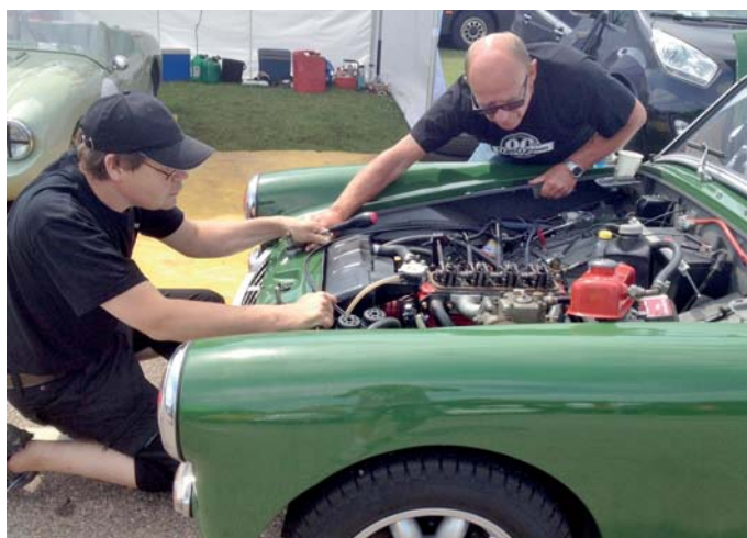
Tord och Magnus fixar ventiljusteringen efter ett av flera topplockspackningsbyten. Foto: Emil Larsson
